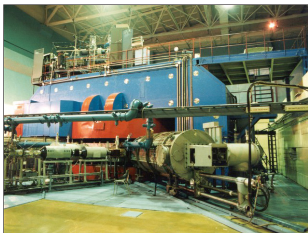
Foto 3. U-400M – ciclotron izocronic pentru accelerarea ionilor grei
