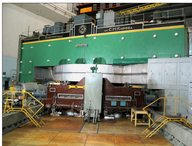
Foto 4. Fazotron – accelerator de protoni cu energia de 680 MeV
