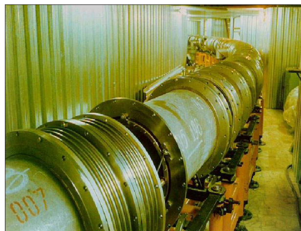
Foto 2. Nuclotronul-M – accelerator supraconductor de protoni și ioni grei
